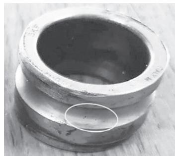
Slika 10. Zamorno trošenje unutarnjeg prstena ležaja (Đurkić, 2018.)
