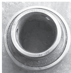
Slika 6. Očišćeni Y-ležaj (Đurkić, 2018.)
