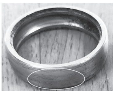
Slika 7. Abrazijsko trošenje vanjskog prstena ležaja (Đurkić, 2018)
