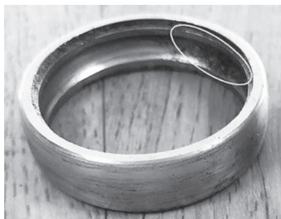
Slika 9. Zamorno trošenje vanjskog prstena ležaja (Đurkić, 2018.)
