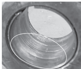
Slika 8. Abrazijsko trošenje unutarnjeg prstena ležaja (Đurkić, 2018.)(Đurkić, 2018.)
