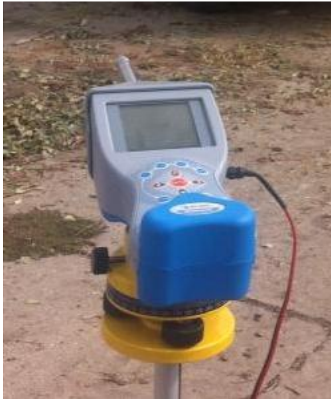
Slika 3. Uređaj METREL tipa Multinorm MI 6201 EU
