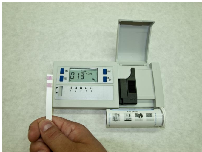
Slika 11.10. Mjerenje koncentracije nitrata mobilnim aparatom Reflectoquant
