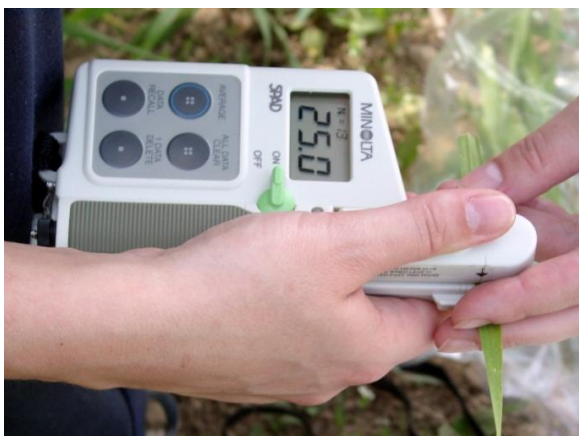
Slika 11.27. SPAD Meter ili klorofilometar
