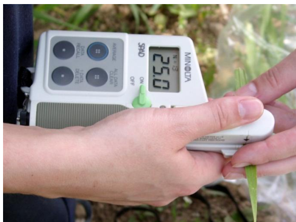
Slika 11.27. SPAD Meter ili klorofilometar
