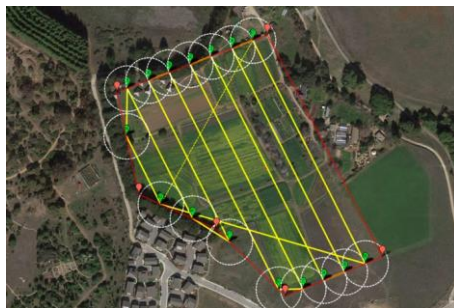
Slika 39. Programirani plan leta drona
