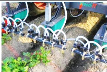
Slika 28. Lokalizirana primjena pesticida
