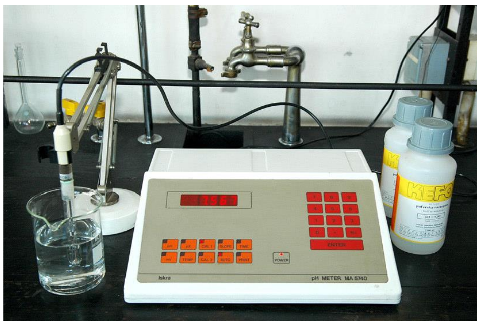
Slika 9. pH metar Iskra MA 5740, ( www.vinogradarstvo.hr )
