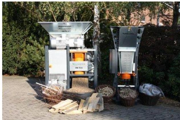
Slika 16. Stroj za peletiranje
