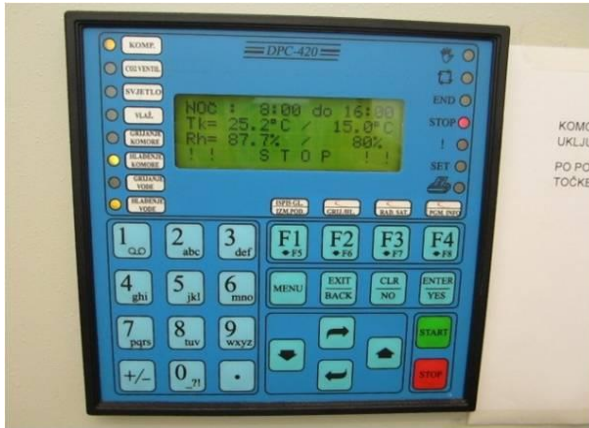
Slika 5. Podešeni parametri klima komore izvor: E. Štefanić
