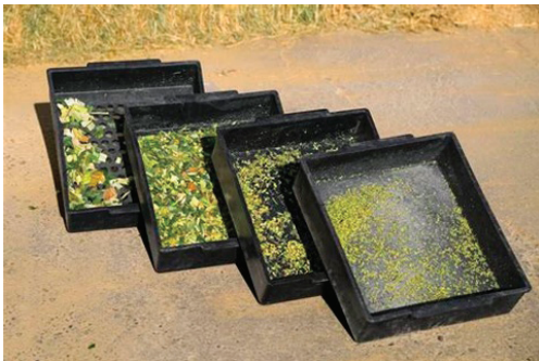
Slika 1. Prikaz određivanja distribucije frakcije čestica u kukuruznoj silaži (Heinrichs, 2013.)
