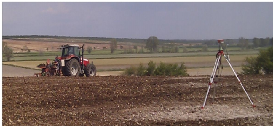
Slika 17. Sustav za navo enje GPS-om (Izvor: Prekalj, 2013.)
