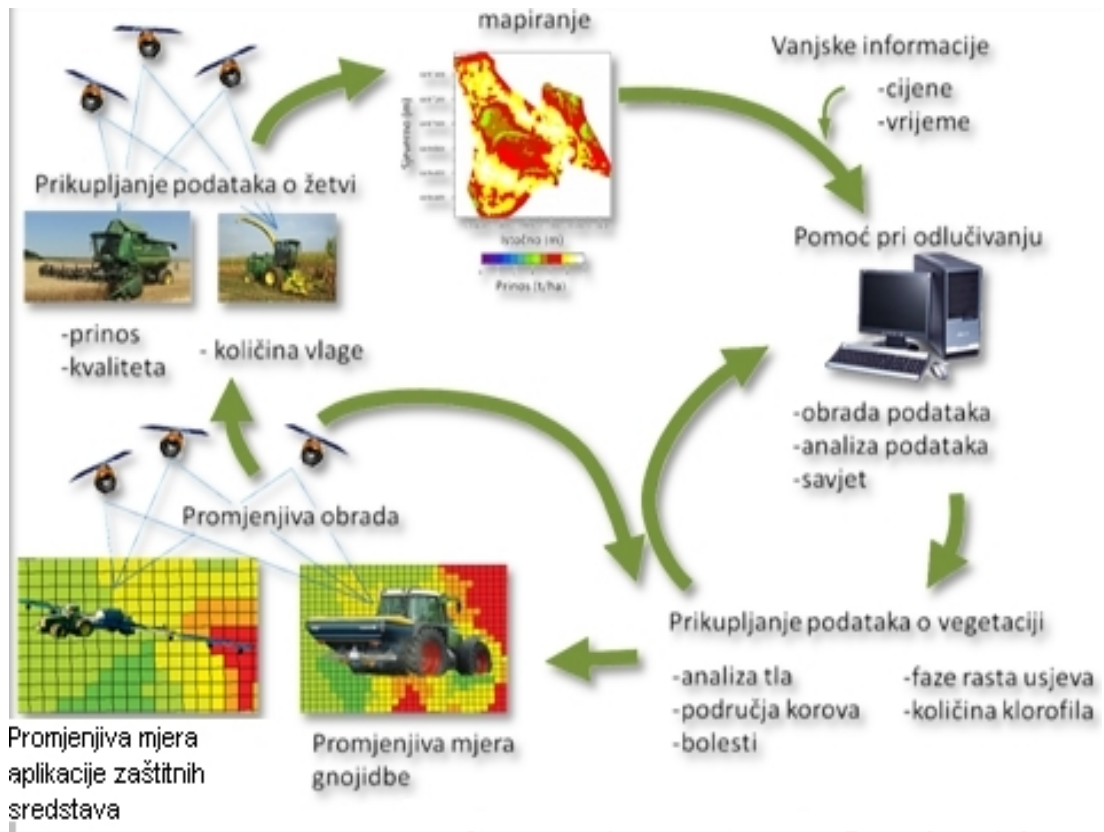
Slika 2. Načela precizne poljoprivrede u prikupljanju podataka, obradi, primjeni i dokumentaciji (Izvor: Martinov, 2008.)
