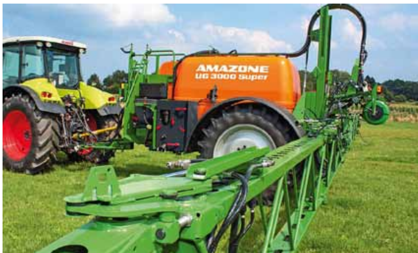
Slika 5. Amazone UG 3000 Super vučena prskalica (Izvor: amazone.net/en/products-digital-solutions/ )
