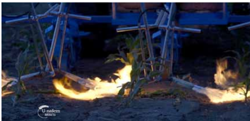
Slika 6. Suzbijanje korova primjenom plamena (Izvor: www.agrosaveti.rs ) Picture 6. Weed control using flame (Source: www. www.agrosaveti.rs )
