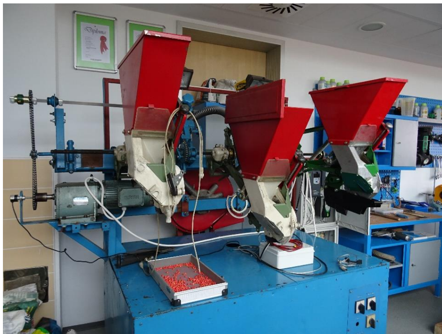
Slika 1. Ispitni stol za provjeru kvalitete rada pneumatskih sijačica
