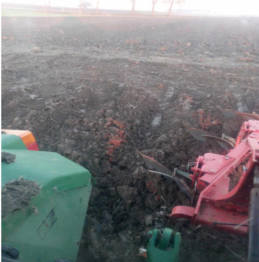
Slika 10. Obrada tla na OPG-u s traktorom John Deere 6110 i plug Vogel Noot L950
