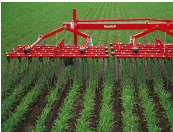
Slika 5. Mehaničko suzbijanje korova u kukuruzu (Foto: PC Daljska polja)
