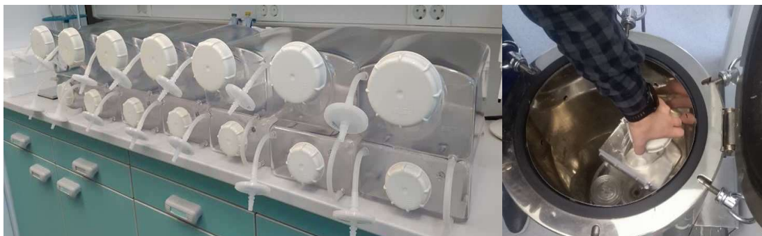
Slika 10. Bioreaktorske jedinice SETIS™ i autoklaviranje komora za rast (Puntarić, 2024.)
