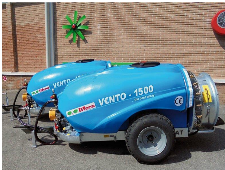
Slika 11. Vučeni raspršivač Tifone Vento 1500 Izvor: https://arapoglou-agro.gr/proionta/aerotourmpina-siromeni-vento/
