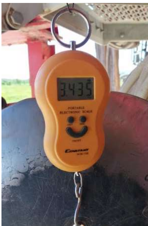
Slika 28. Digitalna vaga „Constant“, tip 14192-115E
