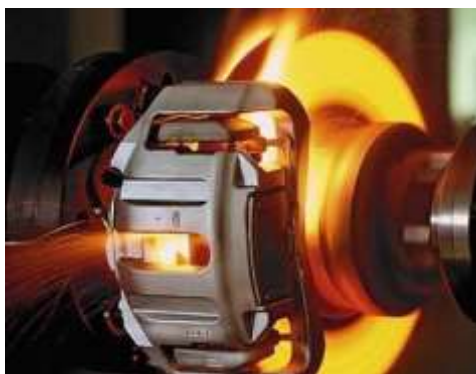
Slika 8. Prekomjerno zagrijavanje kao nuspojava trenja
