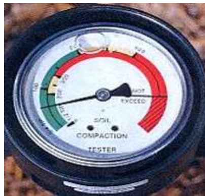
Slika 4. Očitavanje zbijenosti tla
