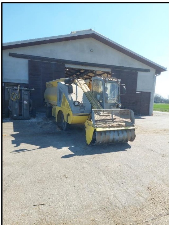
Slika 8. Samohodni stroj za pripremu i raspodjelu hrane - firma Sgariboldi (Izvor: vlastita fotografija)
