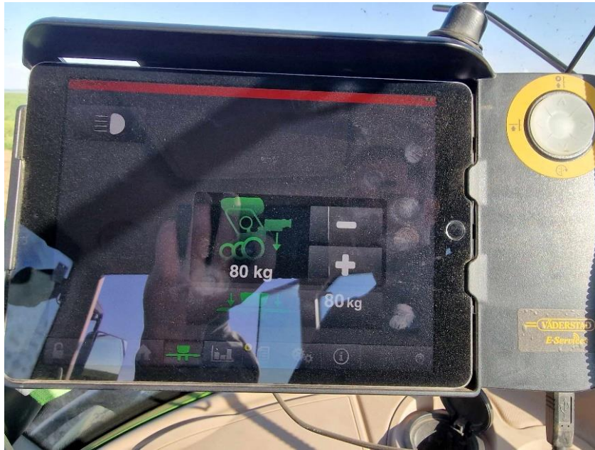
Slika 21: pritisak sjetvene jedinice na tlo (784,4 N/80 kg)
