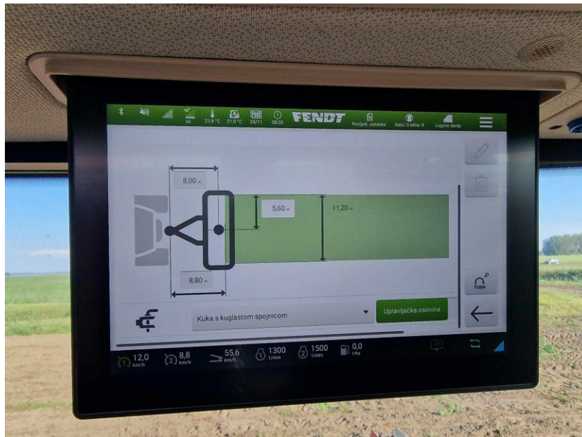
Slika 15: dimenzije priključnog stroja s obzirom na pogonski
