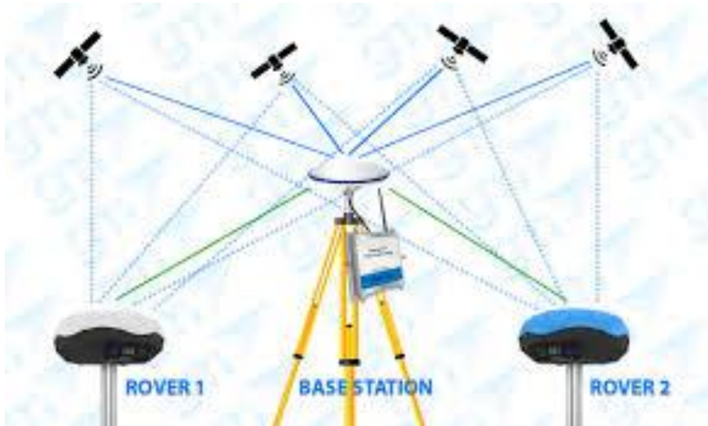
Slika 5: Funkcioniranje RTK tehnologije
