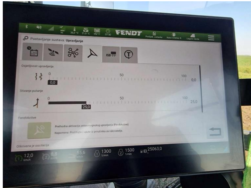
Slika 11: podešavanje osjetljivosti upravljanja i vožnje po trasi
