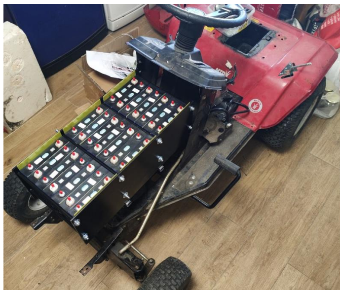
Slika 6. Prikazuje baterije na mjestu benzinskog motora
