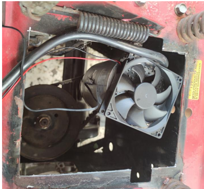
Slika 10. Prikaz hlađenja elektromotora
