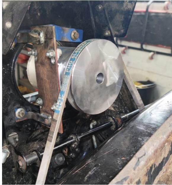
Slika 9. Postavljanje elektromotora na kosilicu
