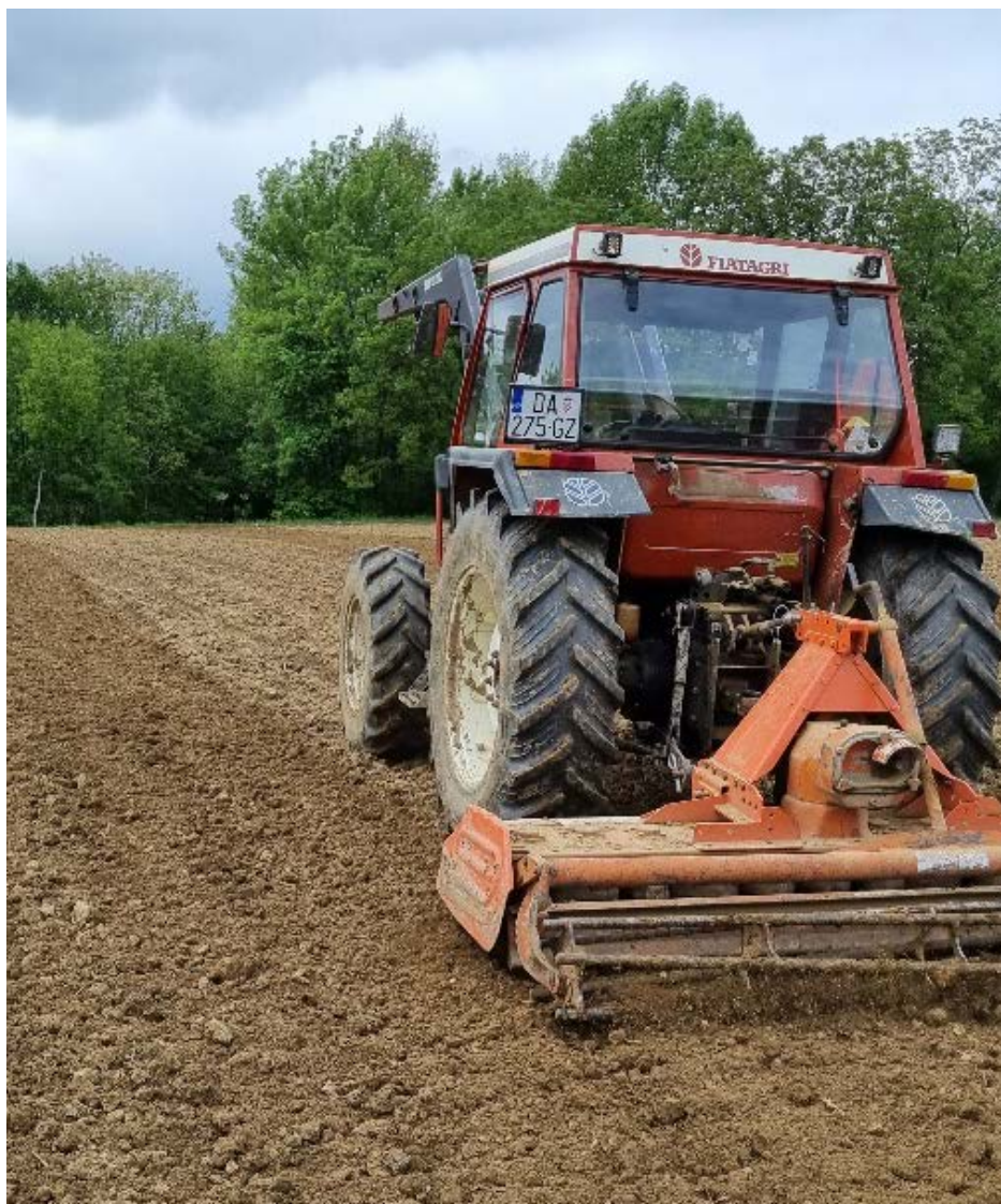
Slika 2. Dopunska obrada tla rotodrljačom
