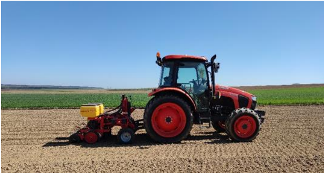
Slika 9. Sjetva suncokreta sijačicom MaterMacc Twin Row-2
