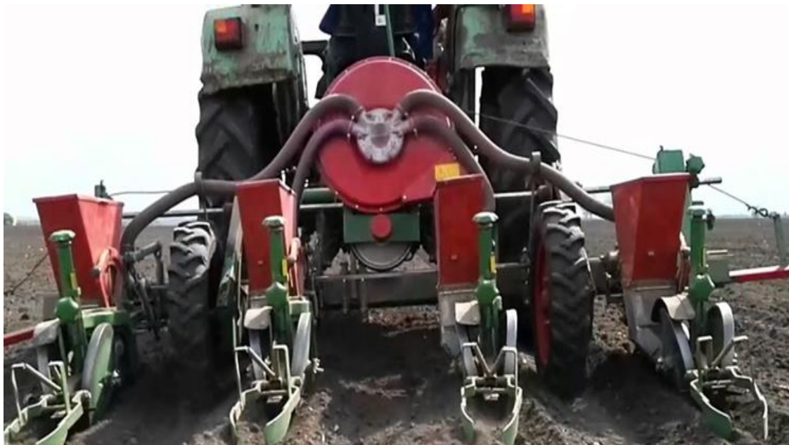
Slika 5. Podtlačna pneumatska sijačica PSK4 tvrtke Future Machines d.o.o. , Osijek Izvor: L. Šefer
