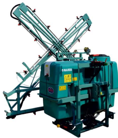
Slika 1. Nošena mehanička ratarska prskalice (Izvor: https://nardi-ngd-nosena-prskalice/ )
