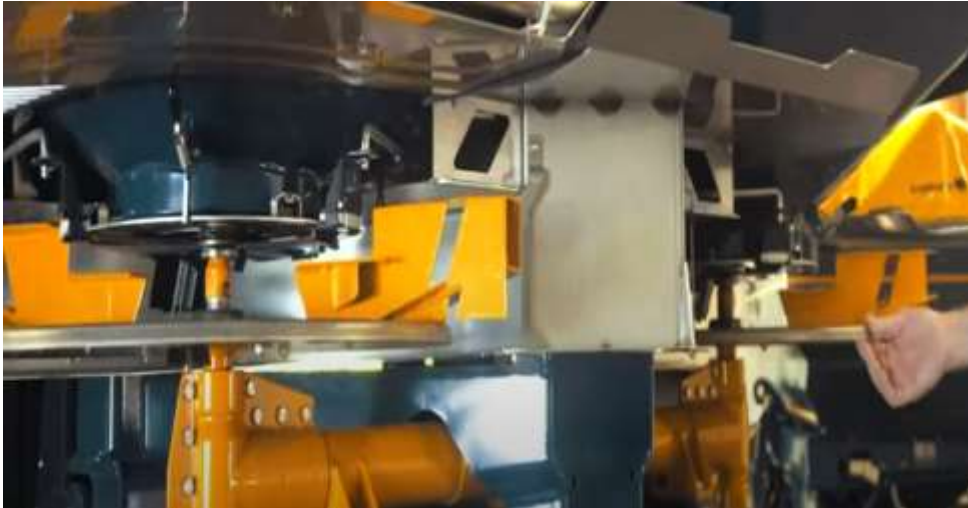
Slika 19. Diskovi na Bogballe rasipaču (YouTube, 2019.)
