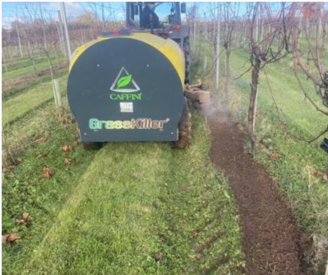
Slika 11. Ekološka kontrola korova zagrijanom pjenom (Izvor: https://www.caffini.com/en/grasskiller/121-grasskiller.html )
