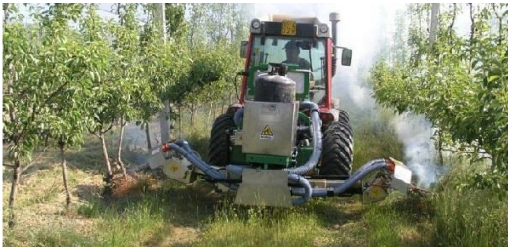
Slika 9. Uništavanje korova plamenom (Izvor: https://www.pakiranje.net/poljoprivredna-mehanizacija/unistavanje-korova-plamenom/ )
