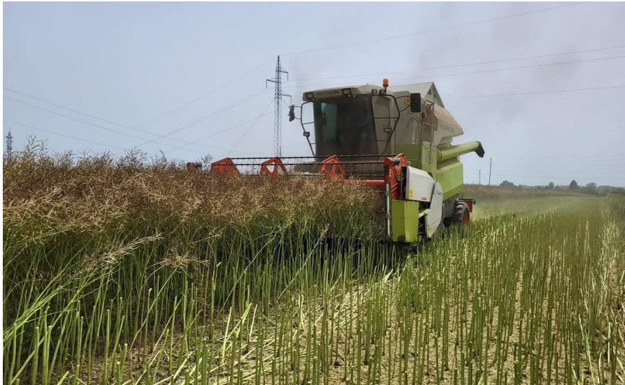
Slika 12. Univerzalni kombajn u žetvi uljane repice
