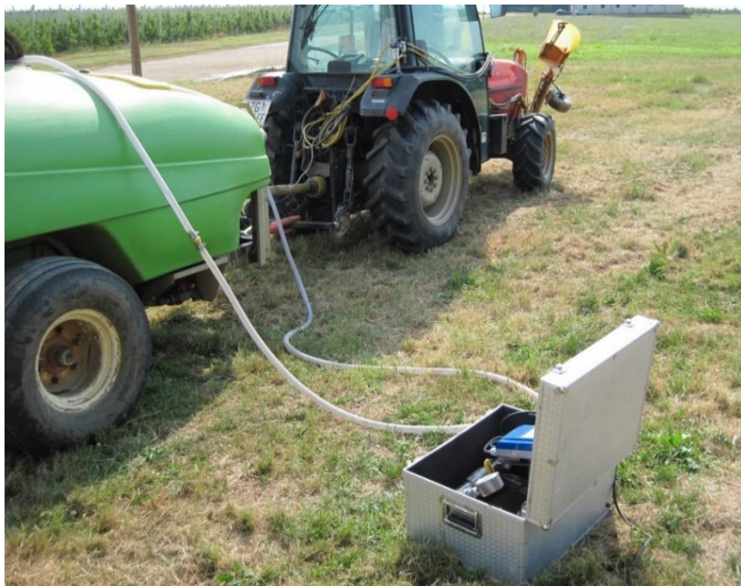
Slika 7. Mjerenje protoke crpke i vraćanje tekućine u spremnik raspršivača
