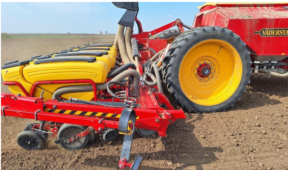
Slika 4. Sjetvena sekcija sijačice Tempo L 8 u radu
