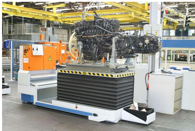
Slika 7. AGV za prijevoz jediničnih tereta
