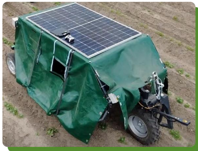
Slika 15. Robot Trabotyx u kultivaciji (Izvor: https://www.trabotyx.com/product.html )
