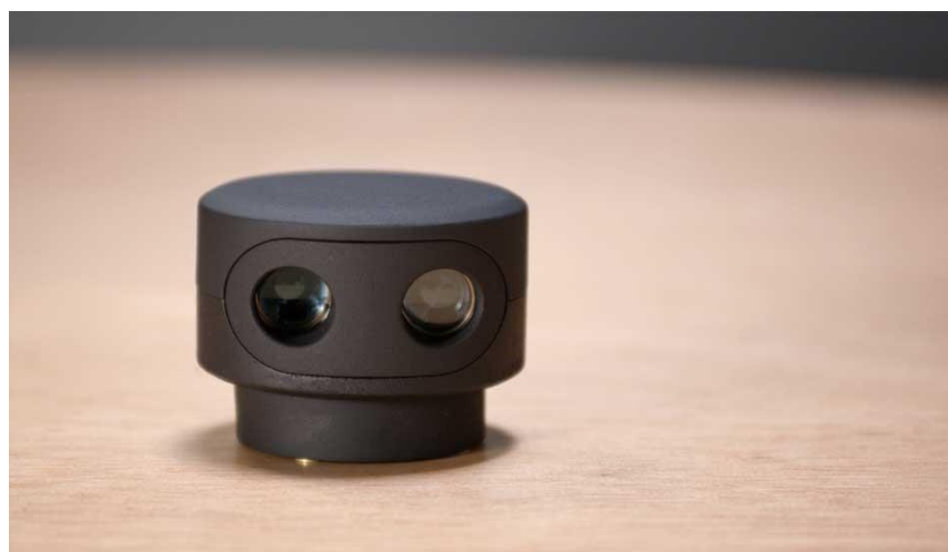
Slika 7. LiDAR senzor (Izvor: SmashingRobotics, 2016.)
