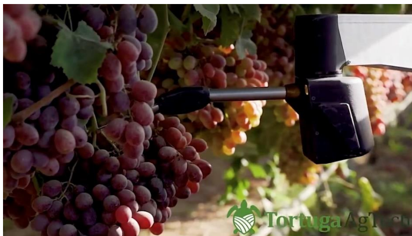
Slika 23. Radni element robota Tortuga AgTech (Izvor: Robot Agricoli, 2024.)
