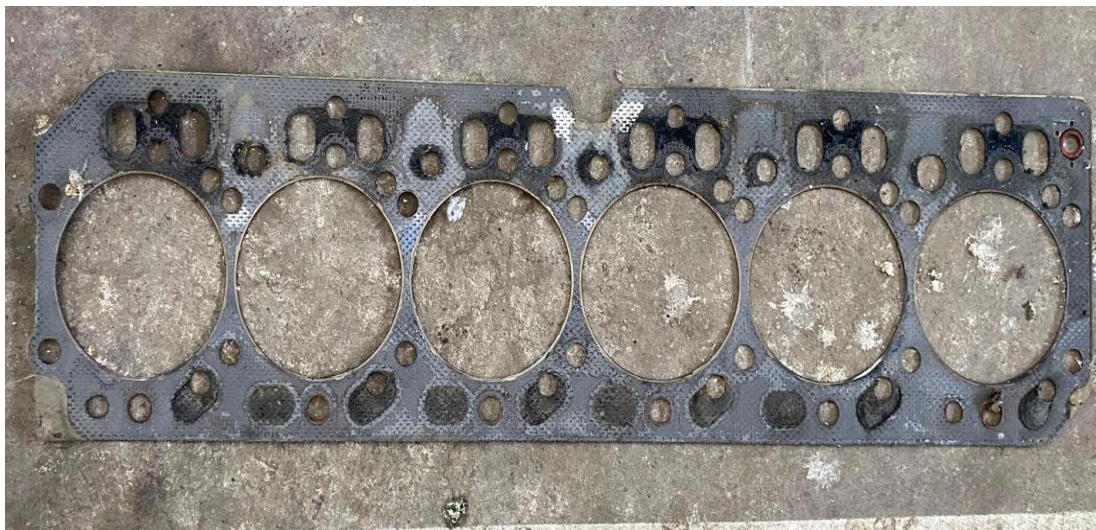
Slika 13. Neispravna brtva glave motora
