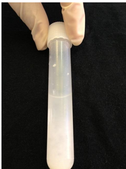
Slika 2. Odvajanje škroba odmah po dodatku etanola (foto original; N. Weg)
