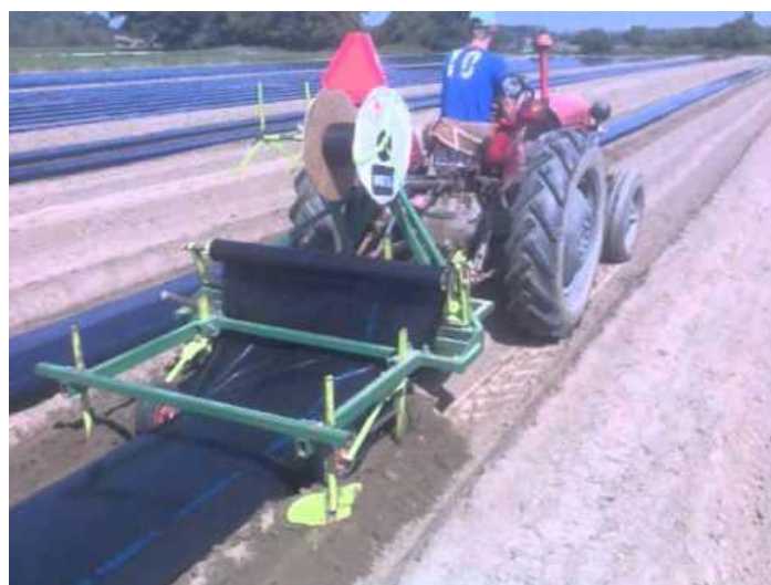
Slika 14. Stroj za postavljanje crne folije i drena za navodnjavanje
