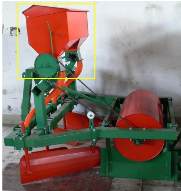
Slika 13. Stroj za formiranje humaka - postavljanje folije i deponiranje gnojiva na humak
