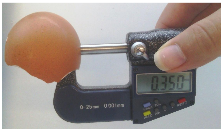
Slika 14. Mjerenje debljine ljuske pomoću elektroničkog mikrometra
