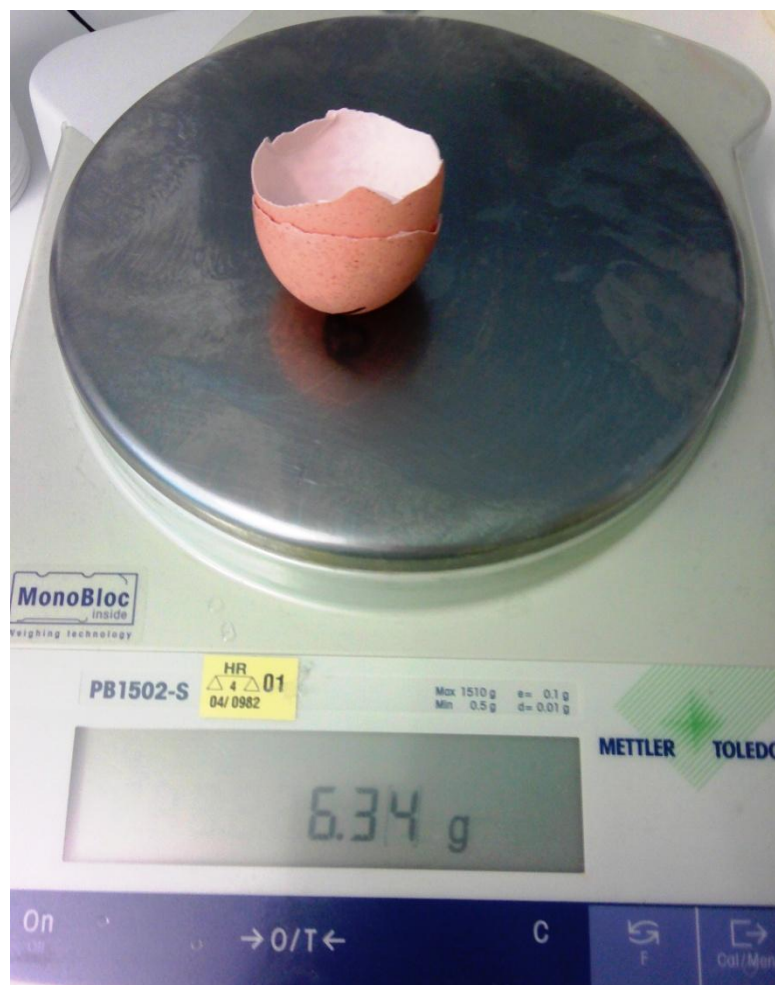
Slika 8. Vaga za mjerenje mase jaja i osnovnih dijelova Mettler Toledo PB 1502 – S; mjerenje mase ljuske
