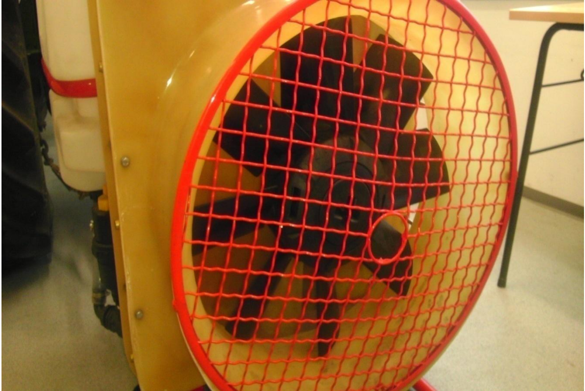
Slika 2. Aksijalni ventilator raspršivača Agromehanika
