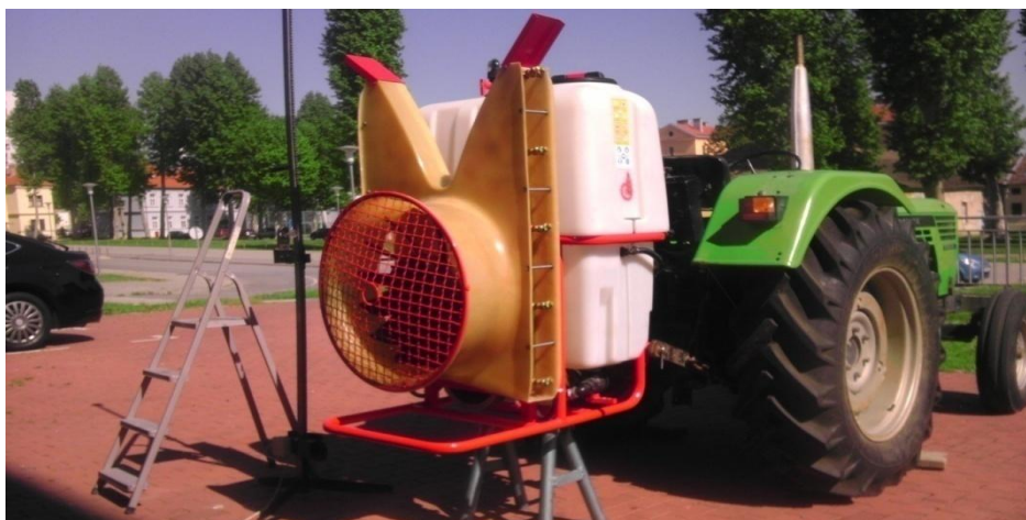
Slika1. Traktorski nošeni raspršivač tvrtke Agromehanika
