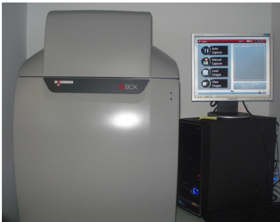
Slika 8. G:Box uređaj za snimanje gela nakon elektroforeze (foto original; T. Platz)
