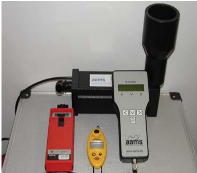
Slika 8. Uređaj AAMS za mjerenje protoka mlaznica (izvor Banaj) (izvor: arhiva Đuro Banaj )
