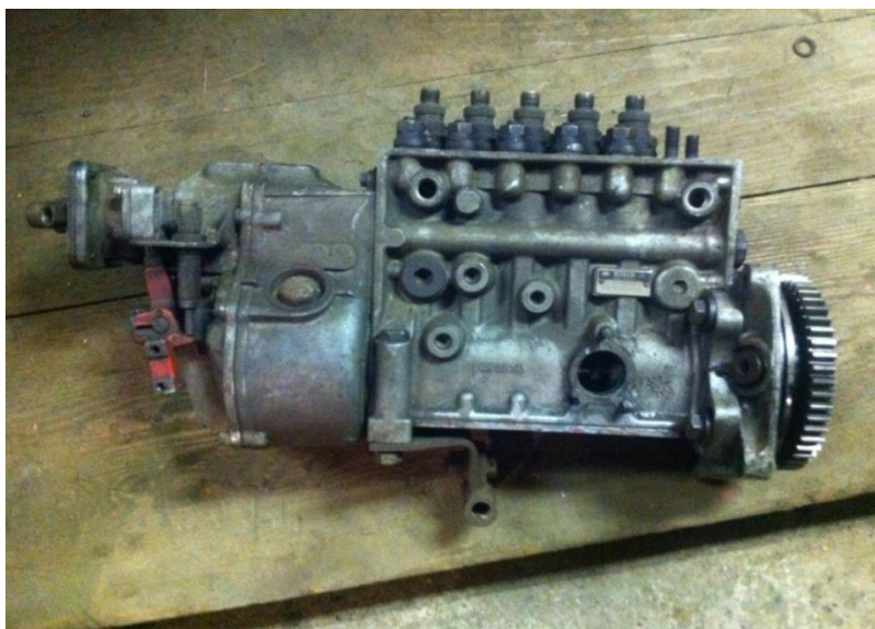
Slika 11. Visokotlačna klipna redna crpka marke „Bosch“
