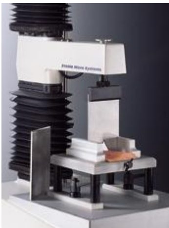
Slika 7. TA.XT Analyser sa priključenim Warner-Bratzler nožem
