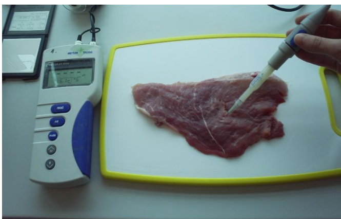
Slika 3. Mjerenje pH na m.semimembranosus
