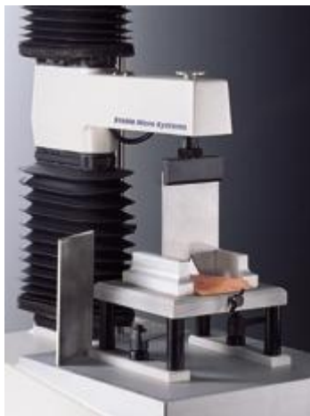
Slika 7. TA.XT Analyser sa priključenim Warner-Bratzler nožem
