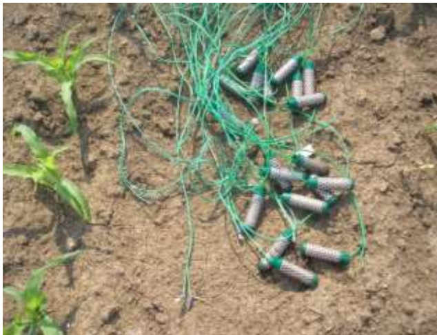
Slika 2. Gipsani blokovi (senzori) „Watermark“ (Fotografija: D. Cerjan, 2011. god. )
