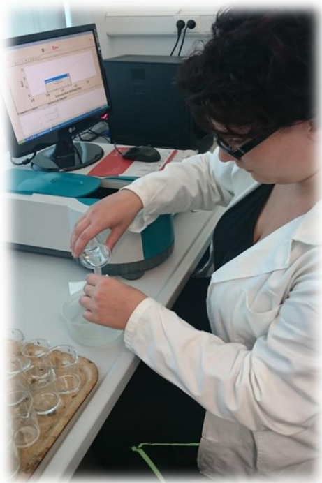
Slika 5. Određivanje nitratnog dušika pomoću spektrofotometra
