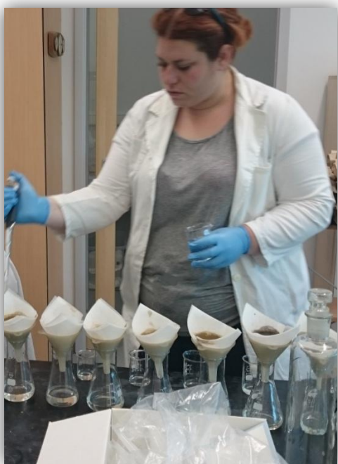
Slika 8. Pipetiranje 10%-tne H_2SO_4 u filtrate
