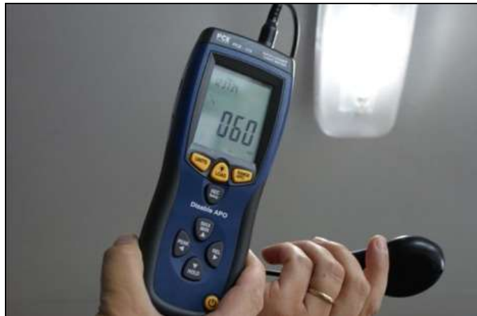
Slika 7. Suvremeni mjerni uređaji za mjerenje jačine svjetla u objektu (tip PCE-174) njemačkog proizvođača PCE Instruments
