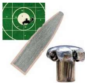
Slika 11. Zrno s blokiranom košuljicom šiljatog mekog vrha
