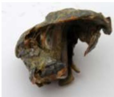
Slika 76. RWS Evolution zrno nakon prolaska kroz tijelo divljači (foto: D. Podlesak)
