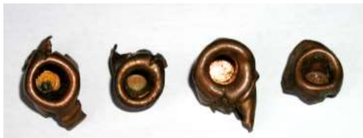
Slika 49. Ostaci košuljice zrna (foto: D. Podlesak)
