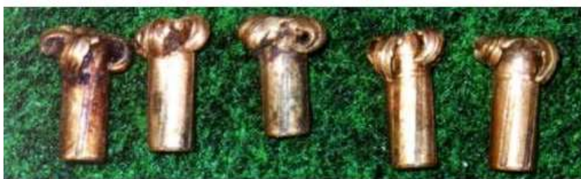
Slika 68. Barnes X zrno nakon prolaska kroz tijelo divljači (foto: D. Podlesak)
