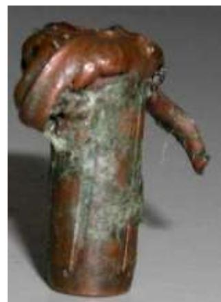
Slika 63. Barnes X zrno nakon odstrjela (foto: D. Podlesak)
