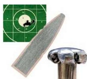
Slika 11. Zrno s blokiranom košuljicom šiljatog mekog vrha
