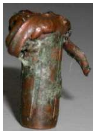
Slika 63. Barnes X zrno nakon odstrjela (foto: D. Podlesak)
