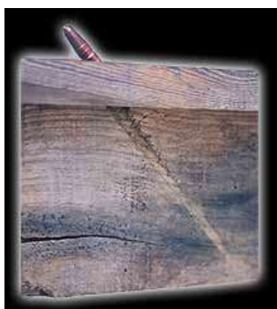
Slika 41. Zrno – prolaz kroz drvo (izvor: www.roc-import.com)
