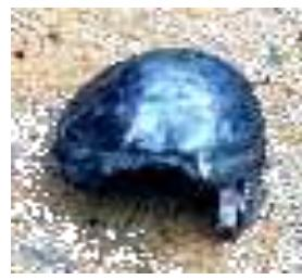
Slika 51. Karakteristična „gljiva“ Hammerhead zrna nakon odstrjela (foto: D. Podlesak)
