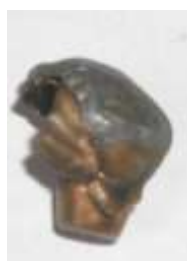
Slika 52. Hornady zrno nakon prolaska kroz trup divljači (foto: D. Podlesak)
