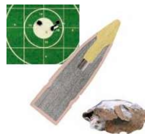
Slika 12. Zrno Bronze Point s karakterističnim širenjem zrna
