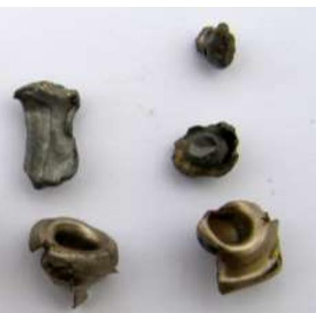
Slika 59. Ostatci Breneke TUG zrna nakon odstrjela divljači – odvajanje olovne košuljice (foto: D. Podlesak)
