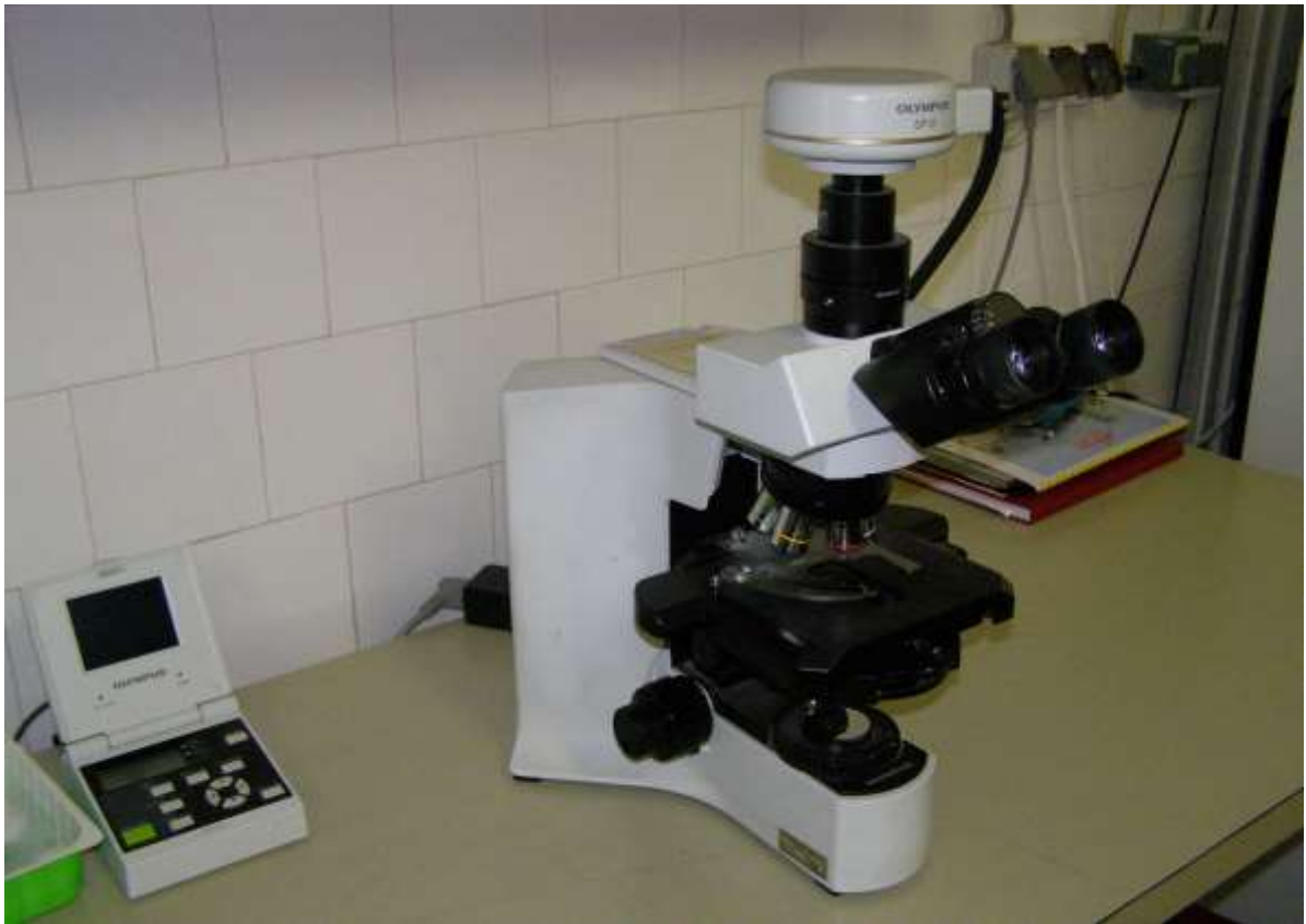
Slika 6 Svjetlosni mikroskop s digitalnim fotoaparatom
