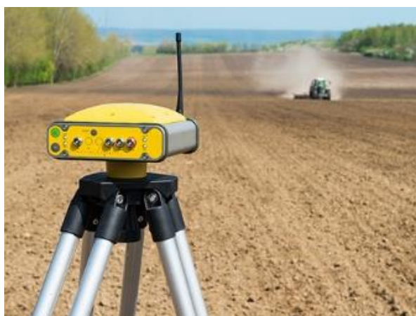
Slika 9. Bazna stanica za RTK metodu
