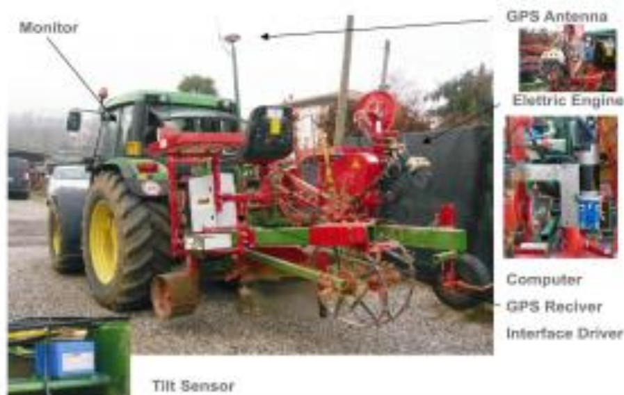
Slika 45. Komponente GPS sustava za navođenje
