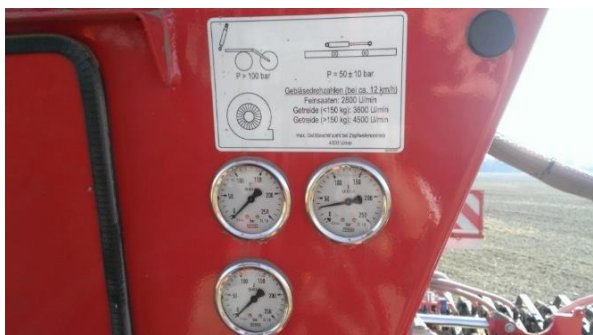
Slika 15. Instrumenti za očitavanje veličina rada ventilatora
