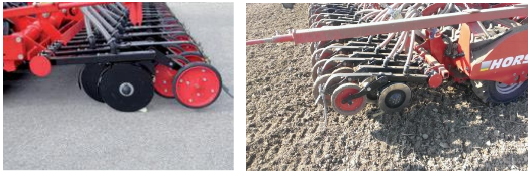
Slika 20. Sklop raonika za sijanje
