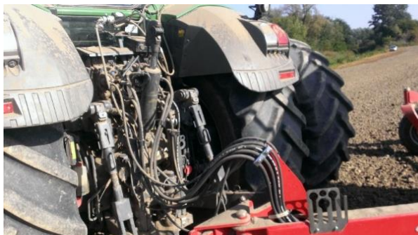
Slika 13. Prikopčavanje traktora i sijačice
