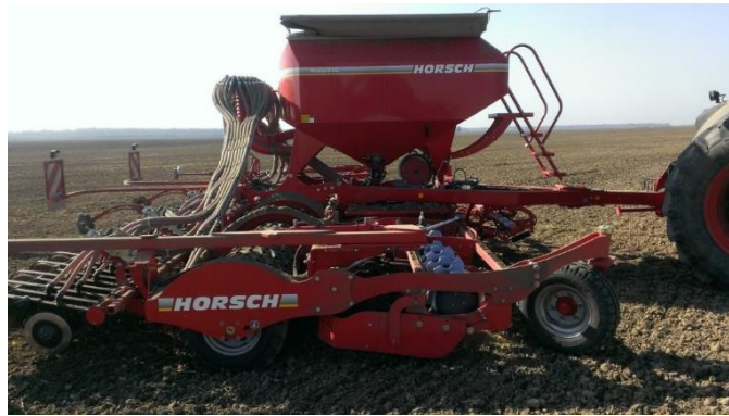
Slika 16. Sijačica Horsch Pronto 8 DC; spremnik s poklopcem
