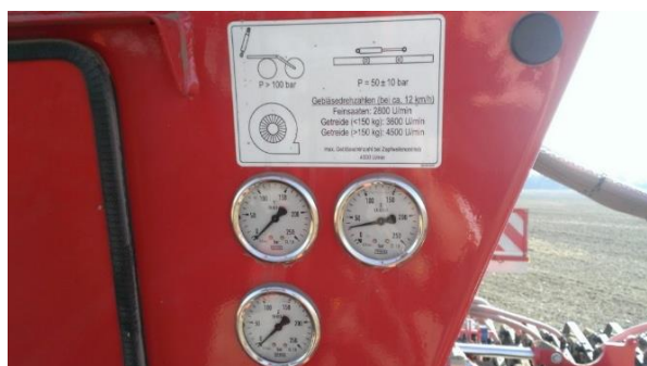
Slika 15. Instrumenti za očitavanje veličina rada ventilatora
