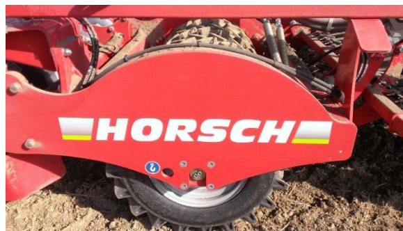
Slika 19. Paker valjak s pneumaticima
