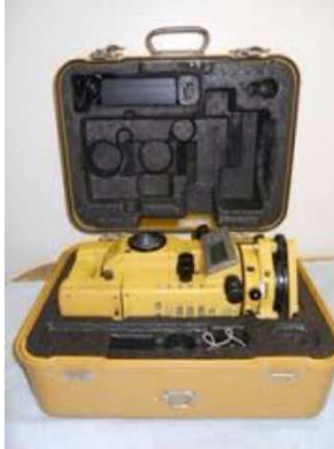
Slika 2.: Totalna stanica za geodetska snimanja. TOPCON GTS 300
