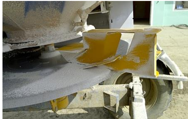
Slika 34. Lopatica za MAP na rasipaču Bogballe M3W (vlastiti izvor)
