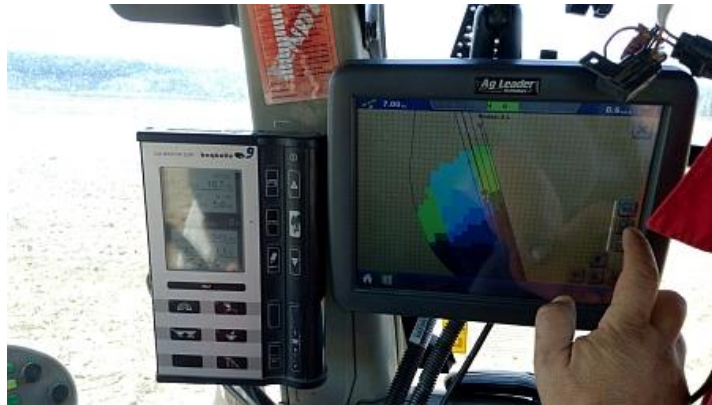
Slika 31. Kalibrator Bogballe ZURF i prikaz preporuke gnojidbe na monitoru Integra (vlastiti izvor)
