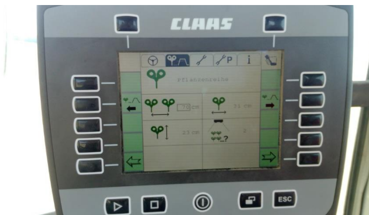
Slika 12. Podešavanje parametara kamere na monitoru
