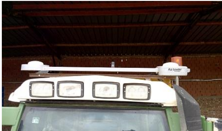
Slika 33. GPS antena montirana na krov traktora
