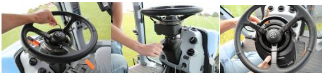
Slika 5. Instalacija sustava Ag Leader OnTrack3 (tzv. “Lock-n’-Roll” instalacija)
